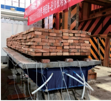
图 10 试验梁加载 Fig. 10 Loading of test beam
