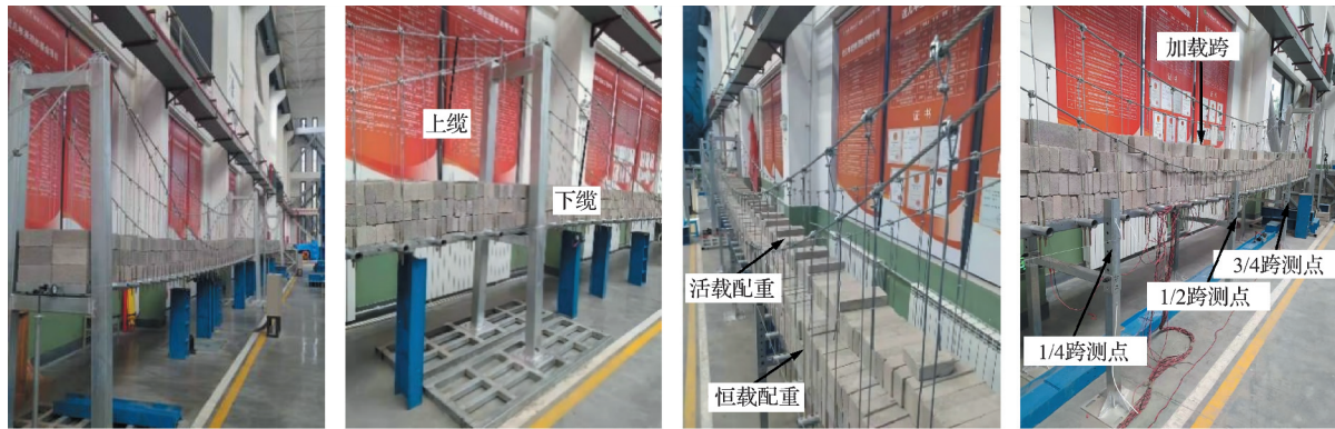
(a) 成桥模型 (a) Model of the bridge-forming state (b) 上缆变下缆布局 (b) Top to bottom cable layout (c) 加载 (c) Loading (d) 加劲梁测点布置 (d) Layout of stiffening girder measure point
