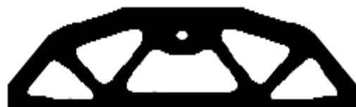
图 2 MBB 梁拓扑设计( l_c=12 \text{ mm}, J=3.72, DV=362 )
