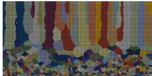
图4 晶体塑性有限元模型
